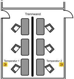
Ein Großraumbüro besitzt zwei Temperatursensoren, um eine möglichst harmonische Regelung zu gewährleisten. Es muss eine Regelung programmiert werden, die aus diesen beiden Temperaturen einen Mittelwert bildet und damit das Ventil/Klappe für die Raumregelung steuert.
