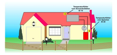
Bei einem Temperaturunterschied von gleich oder mehr als 2K, soll eine Umwälzung des Wassers erfolgen. Die Temperatur vom Sonnenkollektor wird über das Modul ID10 und die des Wasserspeichers vom Modul ID20 aufgenommen. Die Temperaturen müssen so verknüpft werden, dass von der höheren Temperatur des Sonnenkollektors, die niedrigere des Speichers subtrahiert wird.
